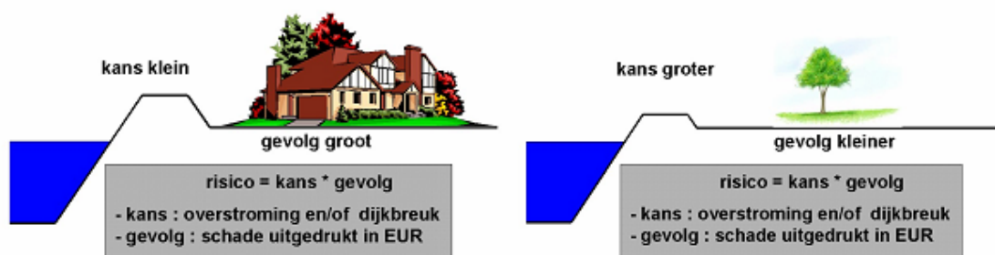
Figuur 5: Investeringskosten en vermeden schade bepalen het na te streven veiligheidsniveau
